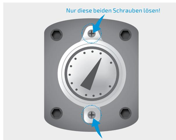
Abb. 2 | Originale Anzeigehuhr entfernen
